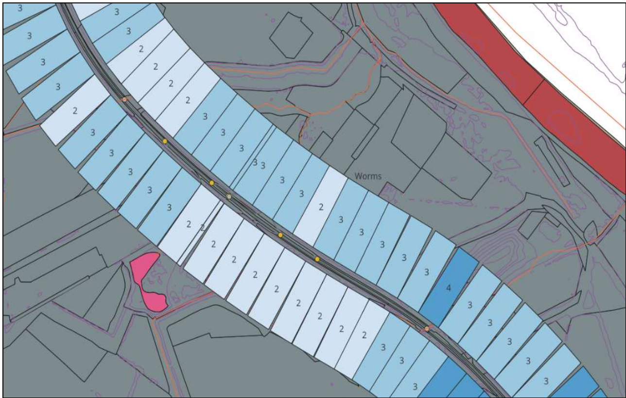
Abbildung 4 Ausschnitt der KI-gestützten Risikoanalyse in GIS für die Zukunftsprojektion: B9 bei Worms (eigene Darstellung)
